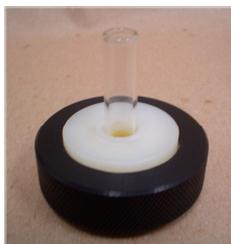
**Figura 3:** Dispositivo de nivelamento
