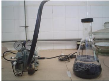
**Figura 5:** Extração de ar da amostra
